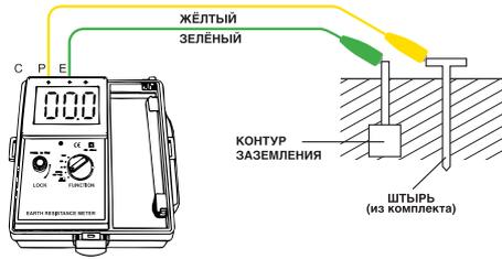
**B** Схема измерения сопротивления заземления (режим ТОЧНО)
