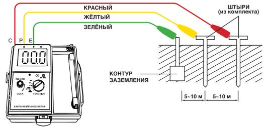
**C** Схема измерения сопротивления заземления (режим ГРУБО)
