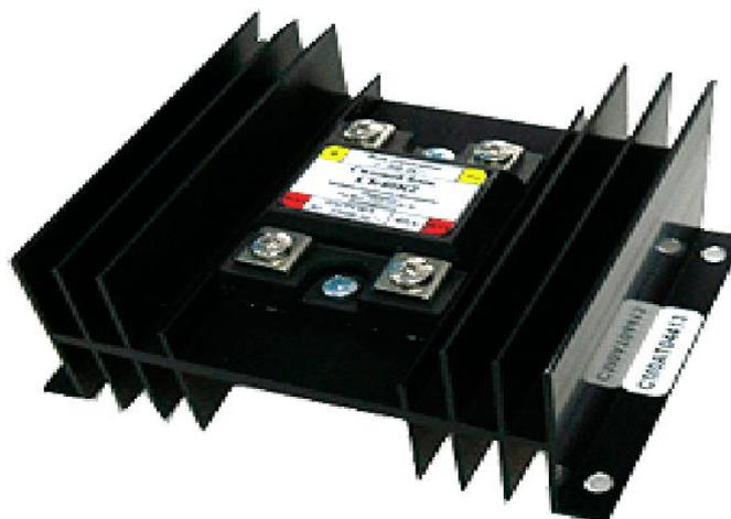
точностью регулирования и надежностью. Другим недостатком работы с пускателем является тяжелый режим работы нагревателя. Включаясь на длительное время на полную мощность, он каждый раз нагревается «докрасна», что сокращает его ресурс работы. Учитывая вышесказанное, мы рекомендуем использовать наши тиристорные силовые блоки, лишенные этих недостатков.
