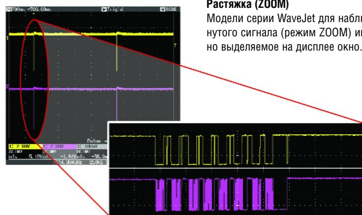
Достаточно нажать кнопку на передней панели для использования функции растяжки, а затем изменить коэффициент растяжки и положение растянутого окна относительно основного с помощью ручек горизонтального управления. Функция растяжки особенно удобна при использовании длинной памяти WaveJet и предлагает наблюдение мельчайших деталей сигнала, которые могут быть пропущены на других осциллографах с короткой памятью.
