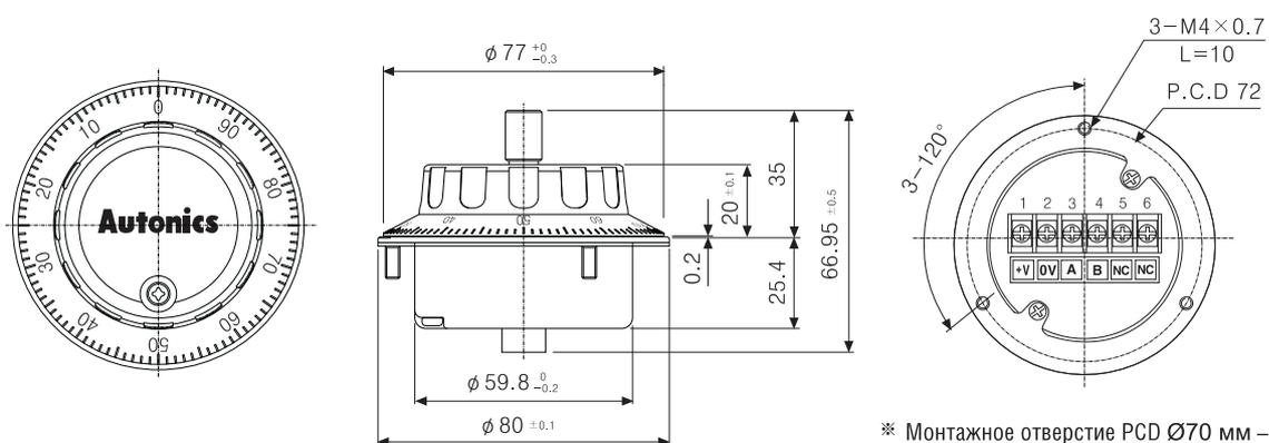
※ Монтажное отверстие PCD  $\phi 70$  мм – опция
