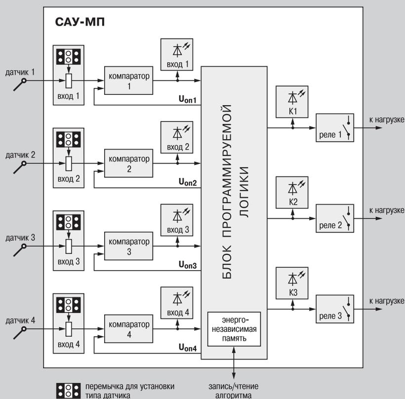
САУ-МП управляет одним, двумя или тремя подающими циркуляционными насосами с помощью **трех выходных э/м реле 8 А 220 В**. Управление осуществляется по выбранному пользователем алгоритму.
