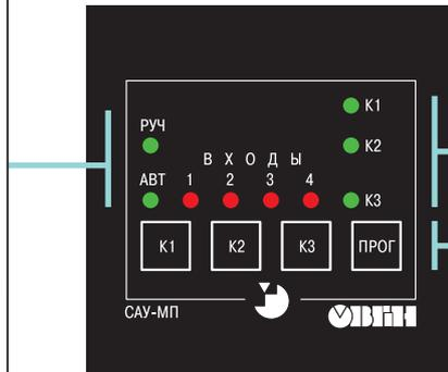
**Светодиоды «K1», «K2», «K3»** в режиме РАБОТА постоянной засветкой показывают состояние соответствующего реле, а мигающей – аварию.
