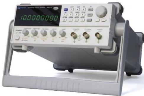
Генераторы сигналов специальной формы
