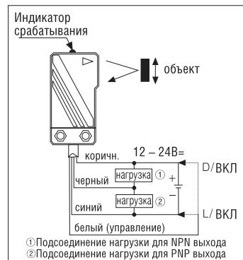
※ Когда линия управления разомкнута, включается режим реагирования на затемнение
