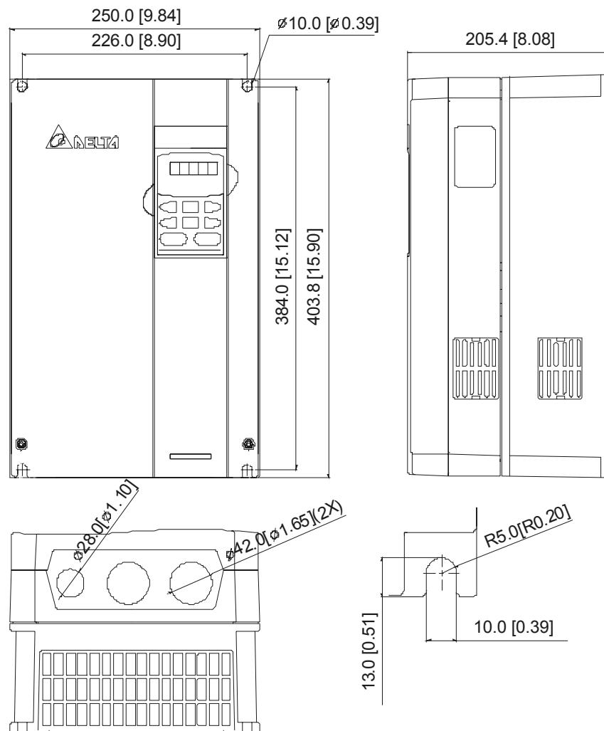
**VFD370F43A-G****VFD450F43A-G****VFD550F43A-G****Размерность: мм (дюймы)**
