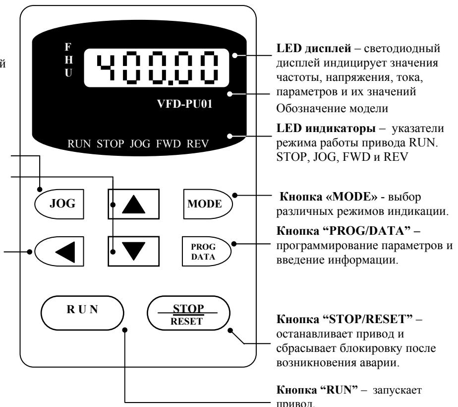
**LED дисплей** – светодиодный дисплей индицирует значения частоты, напряжения, тока, параметров и их значений
