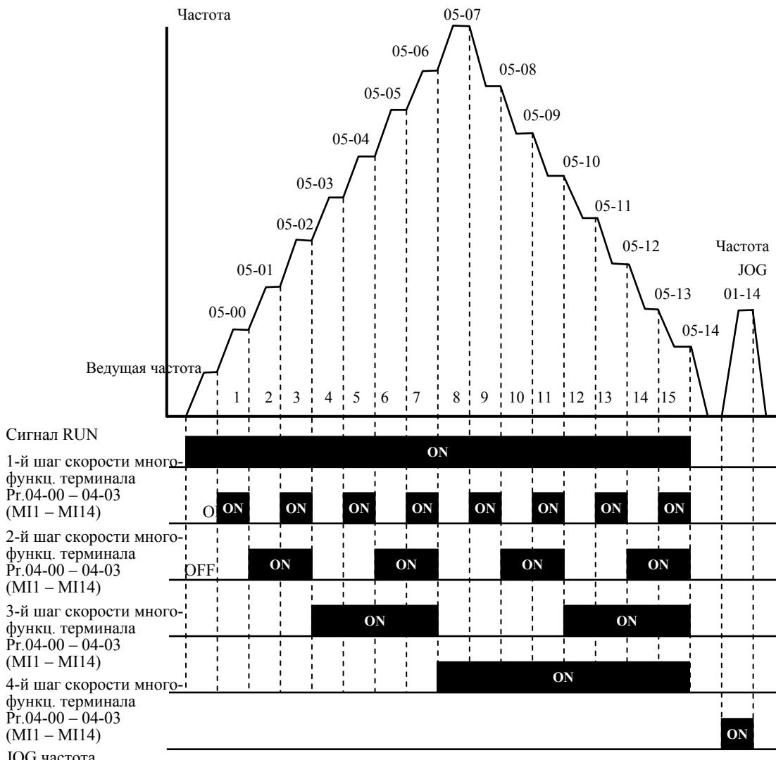
Дискретное управление скоростью через терминалы ДУ
