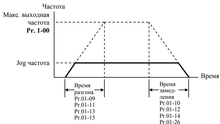
*При установке наименьшего времени разгона/торможения, действительное время разгона/торможения, будет зависеть от реальных механических характеристик системы, таких как момент двигателя и момент инерции.*
