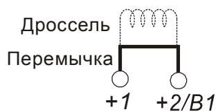
Дроссель в звене постоянного тока используется для фильтрации гармоник в потребляемом от сети токе, увеличении коэффициента мощности, защите от кратковременной асимметрии фаз источника питающего напряжения и других случаях. Перед подключением дросселя снимите перемычку с клемм [+1, +2].
