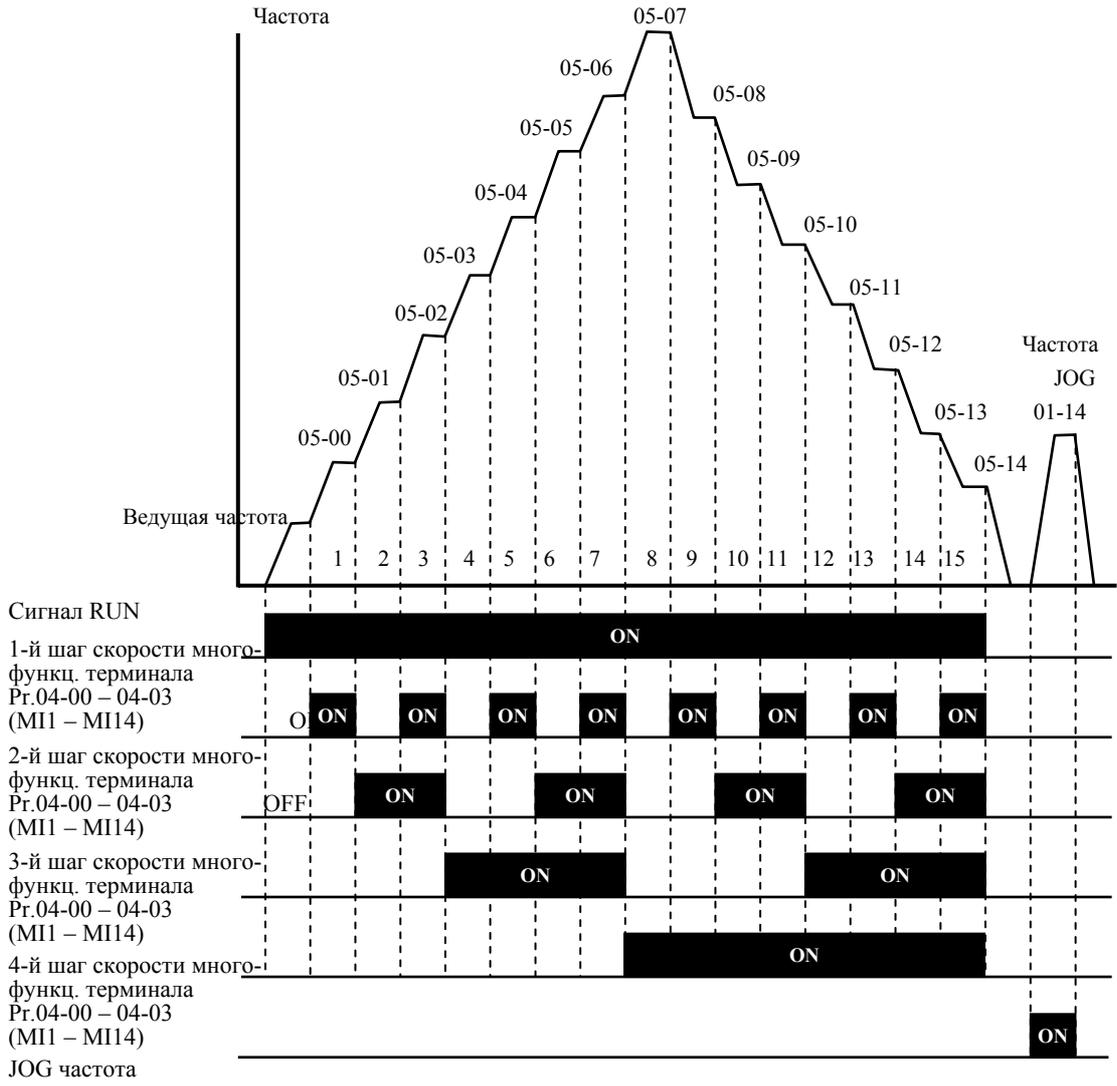
Дискретное управление скоростью через терминалы ДУ
