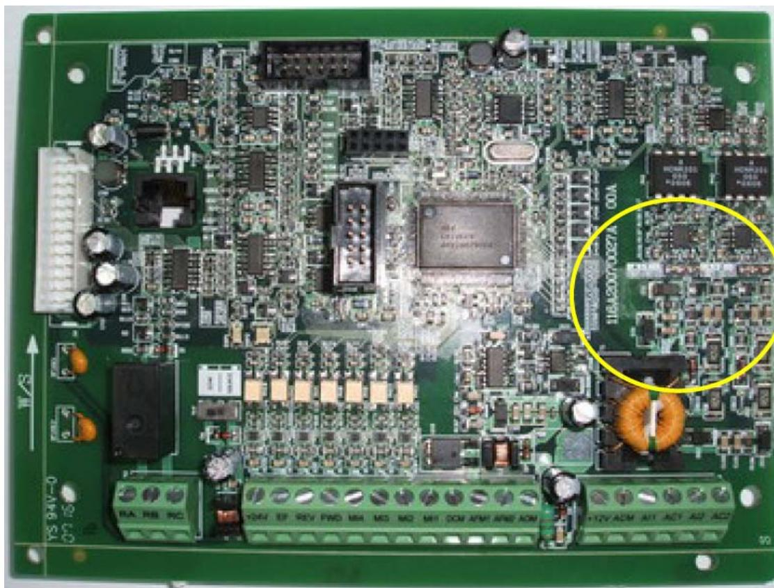
1. При использовании аналогового токового сигнала ( $0\sim 1A$ ), джамперы должны замыкать два левых штырька (выделены красными прямоугольниками), и переключки должны быть установлены (см. желтые стрелочные указатели).
