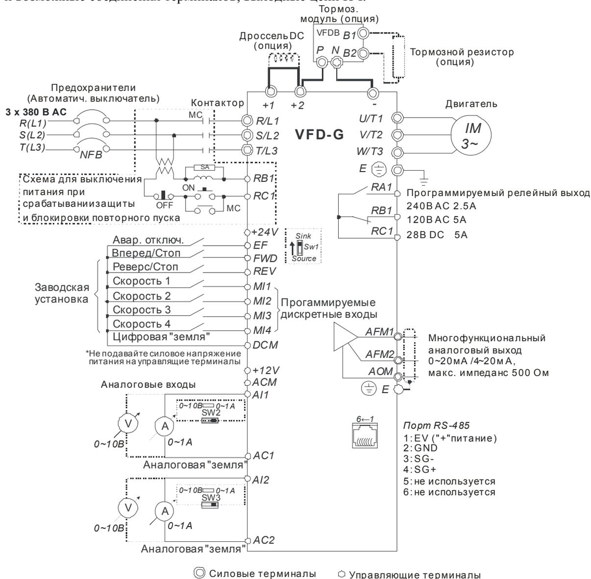
**Примечание:** Не соединяйте коммуникационный порт с модемом или телефоном. Выводы 1 и 2 принадлежат источнику питания дополнительного пульта. Не используйте эти выводы, пока пользуетесь последовательным интерфейсом RS-485.
