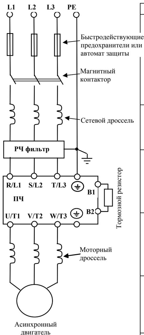
Решение о применении того или иного дополнительного оборудования пользователь принимает самостоятельно в зависимости от условий эксплуатации, режима работы и других эксплуатационных требований.
