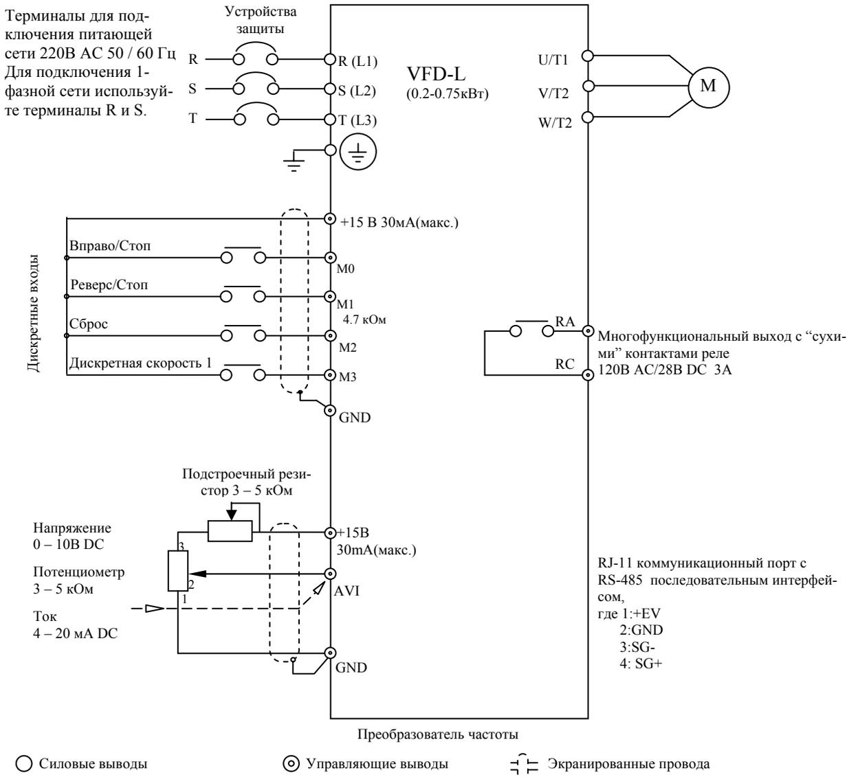
**Примечание:** Не соединяйте коммуникационный порт с модемом или телефоном. Выводы 1 и 2 принадлежат источнику питания внешнего пульта управления PU-02. Не используйте эти выводы, пока пользуетесь последовательным интерфейсом RS-485.
