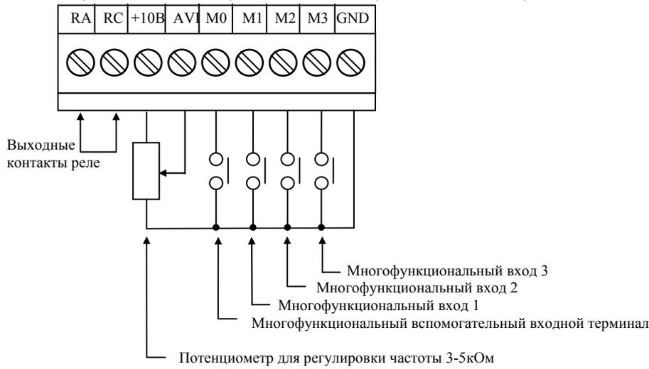
Для моделей VFD004L21D, VFD004L21E, VFD007L21D, VFD007L21E
