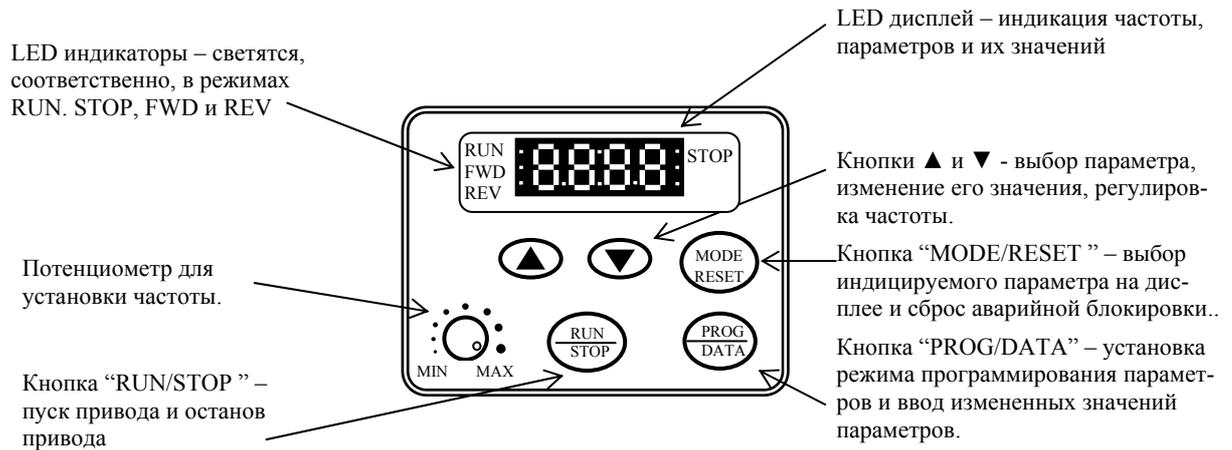
STOP LED указатель светится при нажатой кнопке STOP.
