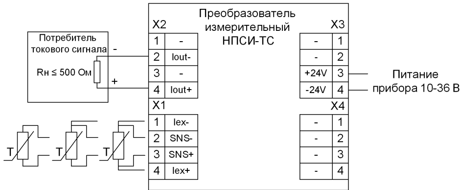
Рисунок 4 – Электрическая схема подключения преобразователя НПСИ-ТС-I-24-X
