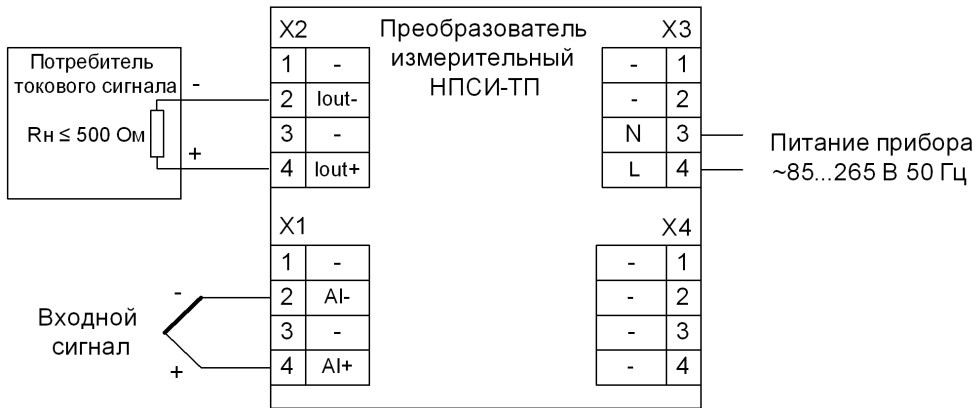
Рисунок 3 – Электрическая схема подключения преобразователя НПСИ-ТП-I-220-X
