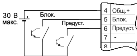
Рисунок 11 – Подключение внешнего источника напряжения для управления дискретными входами
