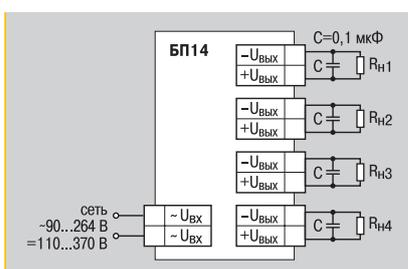
▲ Схема подключения четырехканального блока питания
