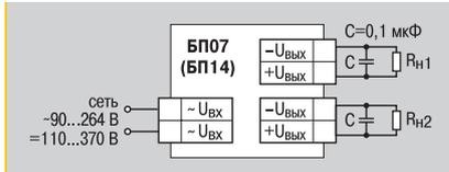
▲ Схема подключения двухканального блока питания
