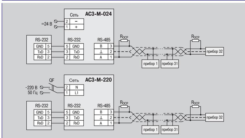
При построении сети с использованием интерфейса связи RS-485 к линии, выполненной витой парой, может быть подключено до 32 приборов, что ограничивается нагрузочной способностью АС3-М.
