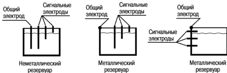
Рисунок 3.5 – Примеры установки кондуктометрических зондов
