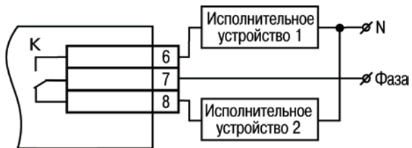
Рисунок Б.3 – Схема подключения нагрузки к ВУ типа Р
