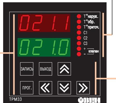
**Кнопка ПРОГ.** предназначена для перехода в режим ПРОСМОТР, а из режима ПРОСМОТР – в режим ПРОГРАММИРОВАНИЕ.
