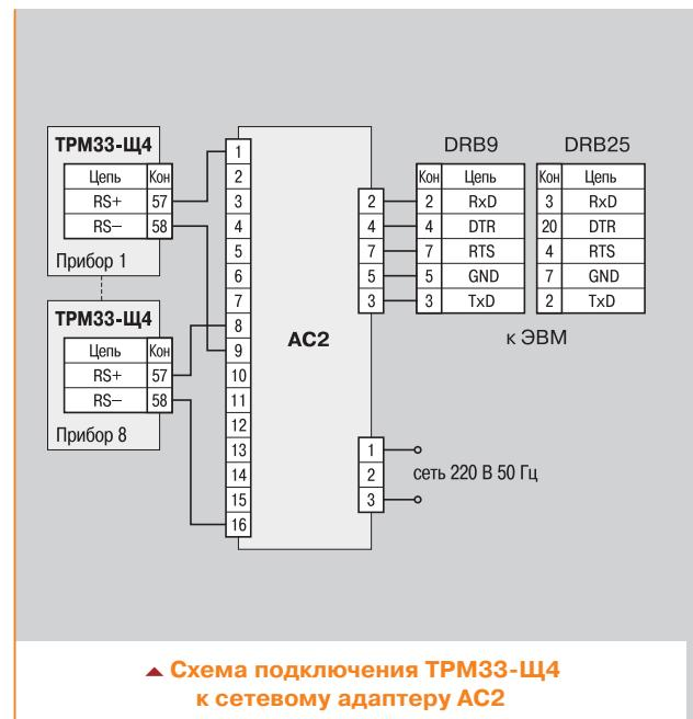
▲ Схема подключения TPM33-Щ4
