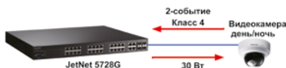
IEEE 802.3at с определением «2-х событий»
